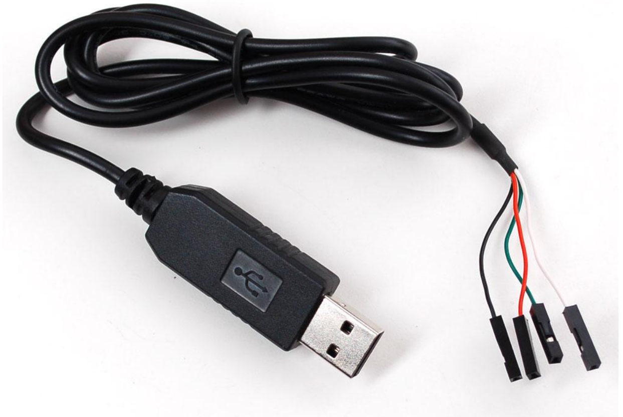
Rysunek 2. Układ PL-2303HX
